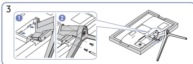
Coloque una tela suave sobre la mesa para proteger el producto y colóquelo sobre la tela de manera que el frente del producto apunte hacia abajo. Presione el soporte montado dentro del cuerpo principal en la dirección de las flechas, como se muestra en la ilustración. Gire completamente el tornillo de conexión en la parte inferior del cuerpo principal.
