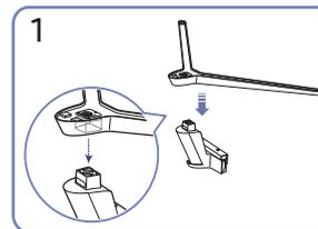
Coloque la base del soporte sobre el cuello del soporte, de acuerdo con la dirección que se muestra en la figura. Compruebe que el conector del soporte esté bien asegurado.
